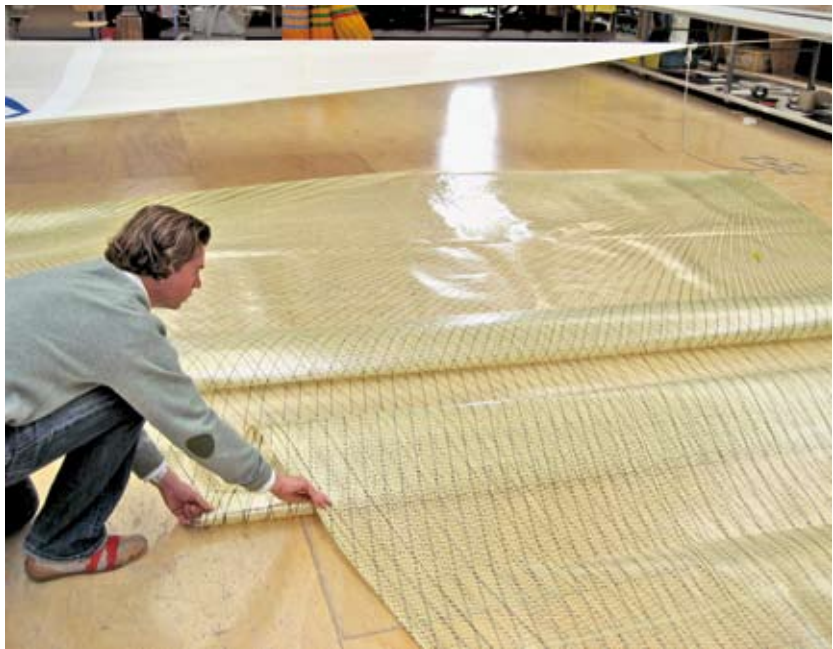
Endmontage eines Membran-Segels. Die Faserverstärkungen wurden schon bei der Tuchproduktion lastgerecht ausgerichtet verklebt, die horizontalen Nähte geben das Profil.
