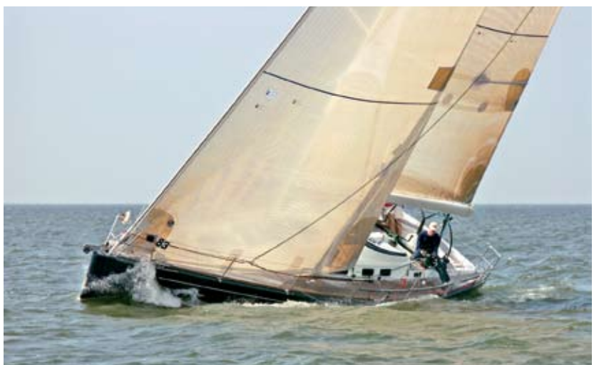
Membran-Segel aus einem Stück werden über profilierten Formen verklebt. Die Technik ist aufwändig und teuer, hat sich aber in Spitzenregatten durch extrem leichte und sehr profiltreue Segel durchgesetzt.
