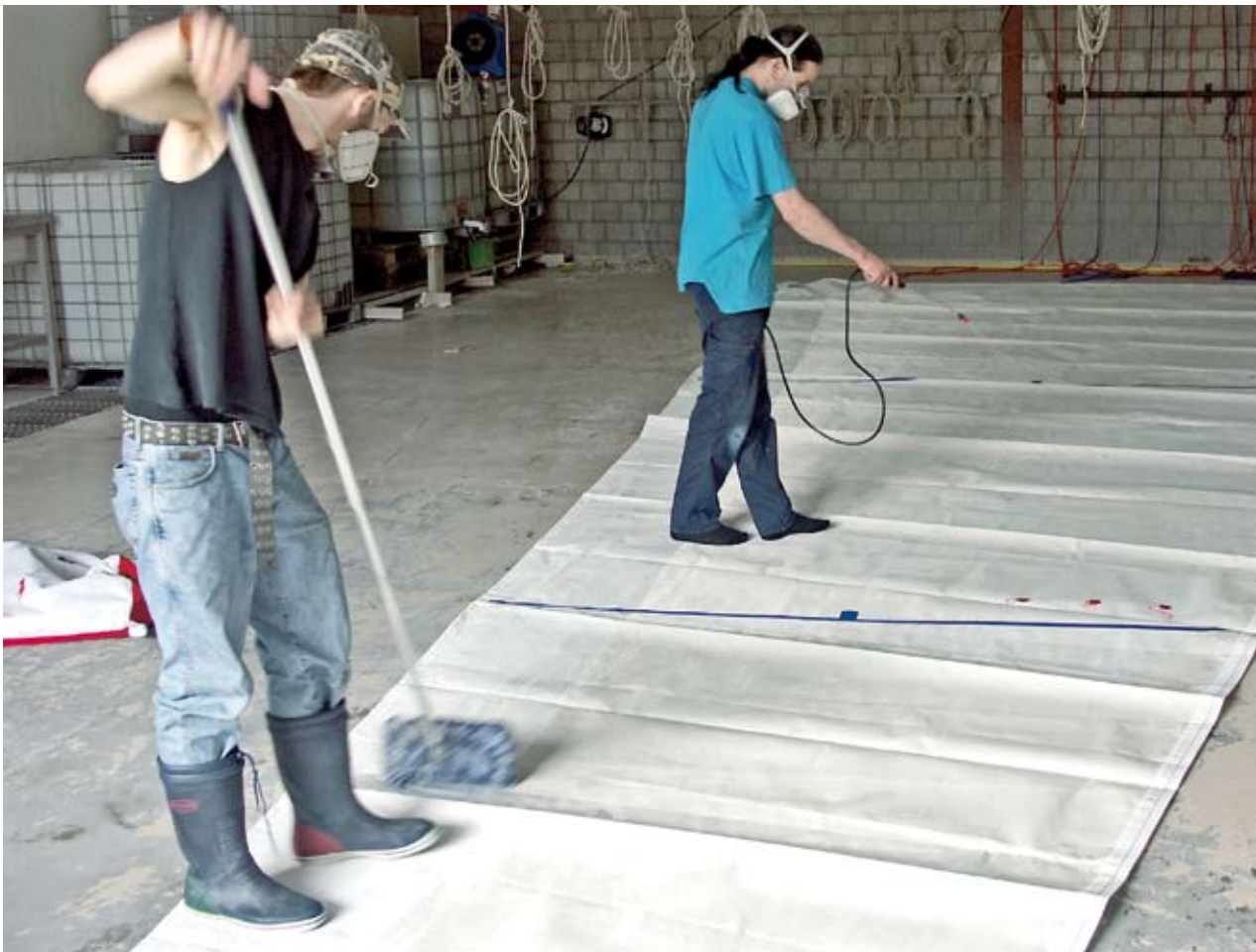
Nachdem die Beschichtung verteilt wurde, wiederholt sich der Vorgang auf der anderen Seite des Segels. Damit sich keine Nano-Partikel in den Atemwegen festsetzen, werden Schutzmasken getragen.
