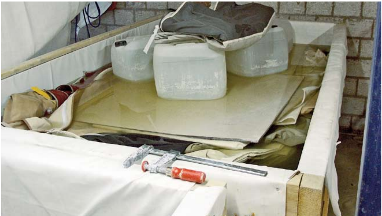
In der Ruhe liegt die Kraft. Professionelle Segelwäschereien setzen heute eher auf chemisches denn auf mechanisches Reinigen, damit das Segel besser geschont wird. Die Einweichphase dauert in der Regel ungefähr zwölf Stunden.
