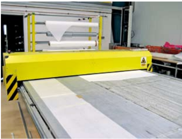
Vom Rechner werden die Daten für den Segelschnitt direkt an einen großen Lasercutter übermittelt, von Hand wird nur noch die Rolle mit dem entsprechenden Tuch eingelegt.
