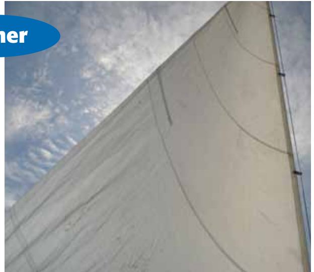
Die Fock wies einen unschönen Knick im Profil entlang der Kurzlatten auf. Das Achterliek war ebenfalls ausgeleierte – das Tuch butterweich sowie mit Rostflecken gesprenkelt.
