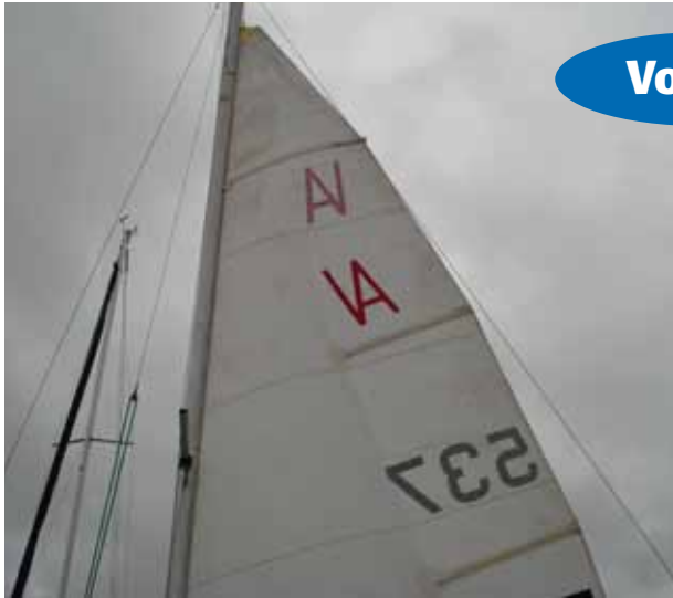
Die Zeit hat an diesem Varianta-Großsegel deutliche Spuren in Gestalt von Stockflecken, einem ausgeleierte Achterliek und einem ausgereckten Profil hinterlassen.
