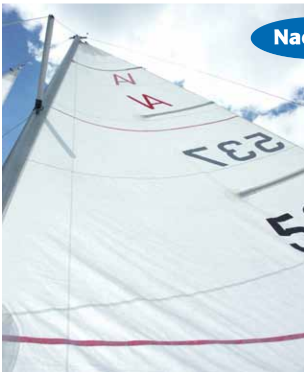
Der Stand des Großsegels liefert keinen Anlass zur Kritik – das Profil ist insgesamt deutlich flacher geworden und lässt sich über die Fall- und Unterliekspannung gut einstellen.
